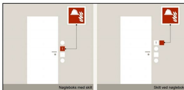
Figur 2 Skiltet skal placeres, så der ved adgangsdøre med flere nøglebokse tydeligt fremgår hvilken nøgleboks, som skal anvendes af redningsberedskabet.
